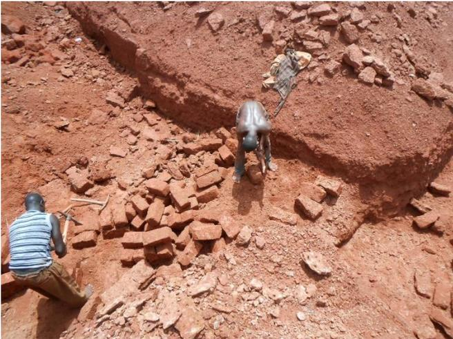
Vengono quindi portate in superficie, dove altri uomini con ascia e piccone le ripuliscono dalla terra e le affinano fino a trasformarle in un parallelepipedo di forma molto regolare.
